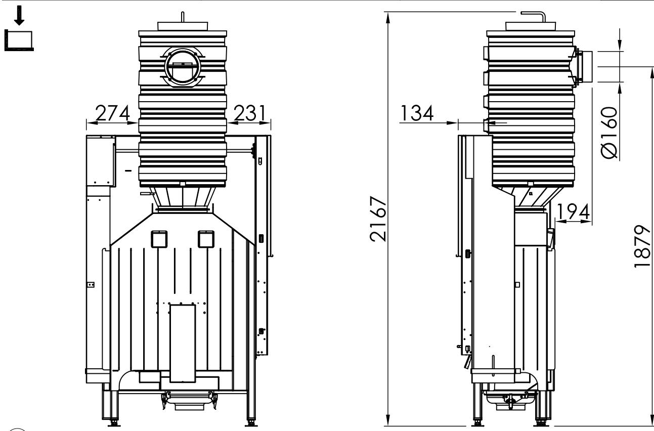
~1:20 sortie arrière, adaptateur excentrique
